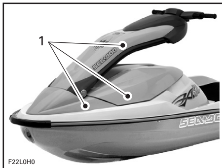
1. Motorabdeckung, Nase und Oberteile der Lenksäule
