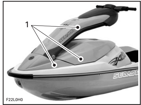
1. Couvercle du compartiment moteur, bout et pièce supérieure de la colonne de direction
