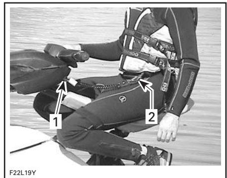
1. Capuchon sur la borne du cordon de sécurité 2. Cordon de sécurité fixé au VFI du conducteur
