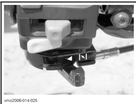
TYPEBILDE – CHOKESPAK I POSISJONEN OFF (AV)
