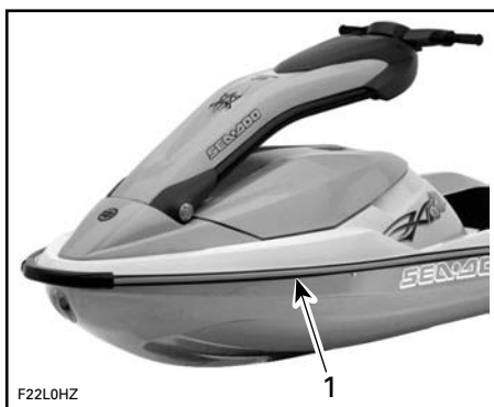
1. Sortie de purge
