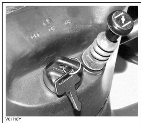
LEVIER D'ÉTRANGLEUR EN POSITION «FULL CHOKE»
