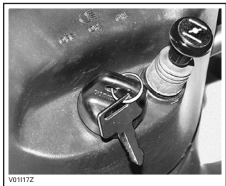
LEVIER D'ÉTRANGLEUR EN POSITION «OFF»
