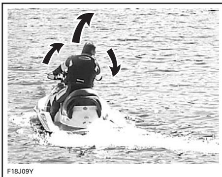
Le déplacement du guidon fait pivoter la tuyère de la turbine pour ainsi diriger la motomarine. Si on tourne le guidon vers la droite, la motomarine tourne à droite, et vice versa. On devrait appuyer sur l'accélérateur pour faire tourner la motomarine.
