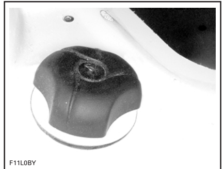
TYPIQUE — BOUCHON DU RÉSERVOIR D'HUILE À INJECTION
