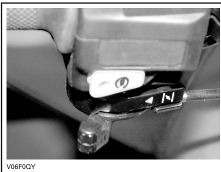
TÍPICA — PALANCA DEL ESTRANGULADOR DE AIRE EN POSICIÓN DE ESTRANGULADOR ABIERTO
