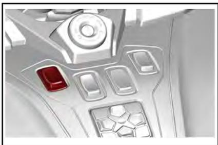
Appuyez sur le haut de l'interrupteur pour lever le pare-brise, ou appuyez sur le bas de l'interrupteur pour l'abaisser.
