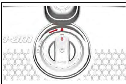
6. Saisissez fermement le compartiment de rangement et vérifiez qu'il est correctement installé et verrouillé sur le véhicule.
