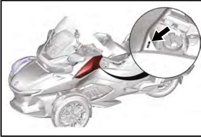
3. Tirez sur le couvercle de service pour le sortir du véhicule.
