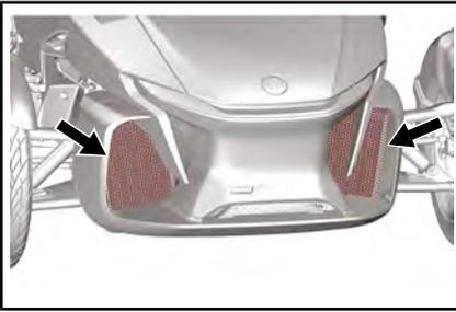
**REMARQUE :** Lorsque le moteur est en marche et que le véhicule est arrêté ou qu'il roule à basse vitesse, les ventilateurs de radiateur poussent l'air vers l'avant du véhicule. Lorsque le véhicule roule à plus grande vitesse, les ventilateurs poussent l'air vers l'arrière du véhicule.
