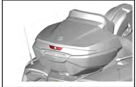
Tirez sur le loquet pour ouvrir le couvercle. Lorsqu'il est verrouillé, tournez la clé d'allumage pour déverrouiller.
