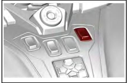
L'interrupteur du siège chauffant sert à mettre ce siège sous et hors tension et à contrôler l'intensité de la chaleur.
