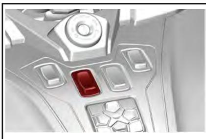
L'interrupteur de poignées chauffantes sert à mettre les poignées chauffantes sous et hors tension et à contrôler l'intensité de la chaleur.
