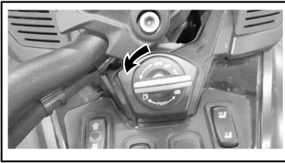
SCHLÜSSELSTELLUNG ZUM ARRETIEREN DES LENKERS
