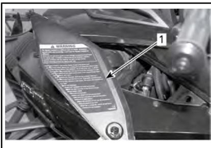
CONFIGURAZIONE TIPICA - SCHEDA DI SICUREZZA SOTTO IL COPERCHIO DI MANUTENZIONE LATERALE SX
