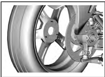
1. Загнутый край направлен внутрь ведущего моста
