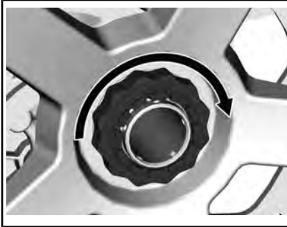
1. L'estremità ripiegata rivolta verso l'interno dell'albero motore.
