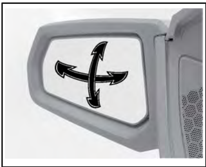
PUNKTER FOR JUSTERING AV SPEIL
