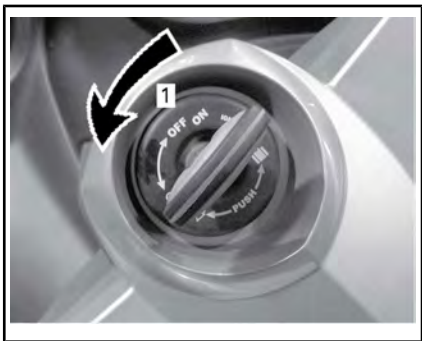
NØKKELSTILLING VED LÅSING AV STYRET
