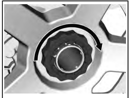
1. Загнутый край направлен внутрь ведущего моста
