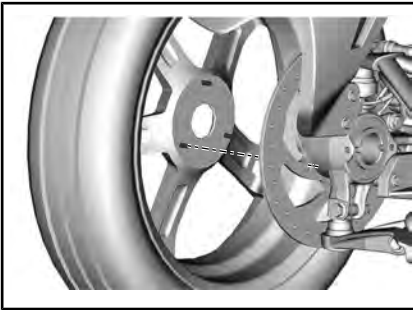
1. Загнутый край направлен внутрь ведущего моста
