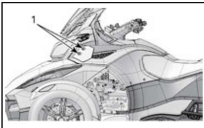
1. Tornillos de sujeción del deflector de viento
