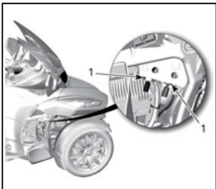
1. Tuercas de sujeción del cable de ajuste
