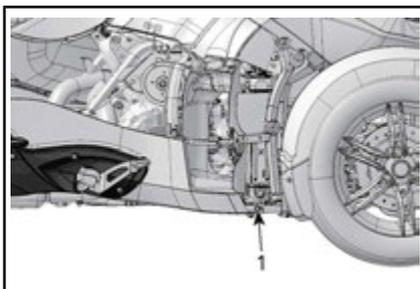
1. Tuerca de fijación de la parte delantera
