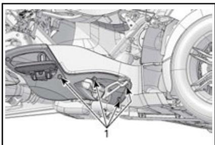
**NOTA:** Se inserta la parte posterior del panel entre el soporte y el soporte de aluminio.
