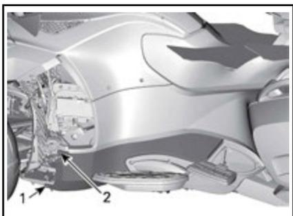
1. Tornillo de sujeción de la parte inferior
