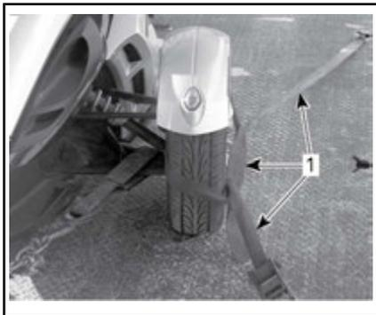
**TÍPICO: FIJACIÓN DE LAS RUEDAS DELANTERAS — SEGUNDO MÉTODO**
