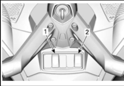
1. Interruptor de empuñaduras con calefacción del conductor
