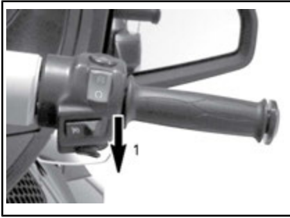
1. Taster zum Setzen bzw. Speichern der Geschwindigkeit nach unten in die Stellung SET drücken
