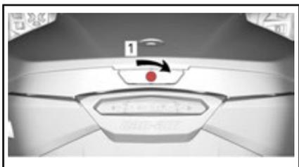
1. Ruotare in senso orario fino al bloccaggio
