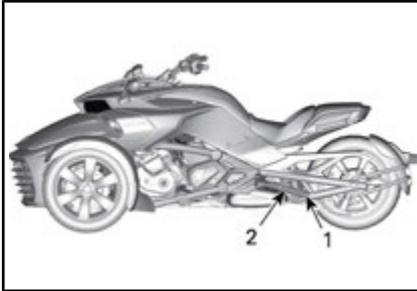
**CONFIGURAZIONE TIPICA - POSIZIONE DELLE ETICHETTE DI CONFORMITÀ**
