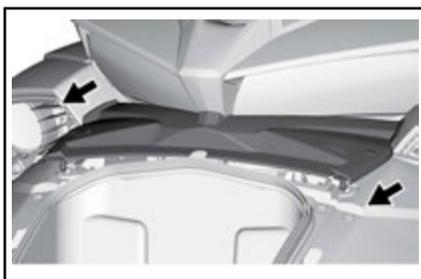
*CONFIGURAZIONE TIPICA - RIMUOVERE IL COPERCHIO DI MANUTENZIONE*
