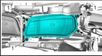
1. Vite di serraggio luce di posizione
