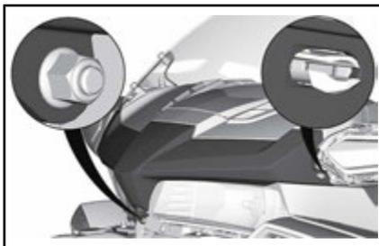
6. Rimuovere il telaio dell'altoparlante.
