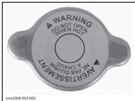
КРЫШКА РАСШИРИТЕЛЬНОГО БАЧКА — НЕ ОТКРЫВАТЬ, ПОКА ДВИГАТЕЛЬ ГОРЯЧИЙ
