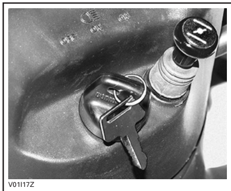
LEVIER D'ÉTRANGLEUR EN POSITION «OFF»
