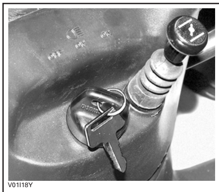
LEVIER D'ÉTRANGLEUR EN POSITION «FULL CHOKE»
