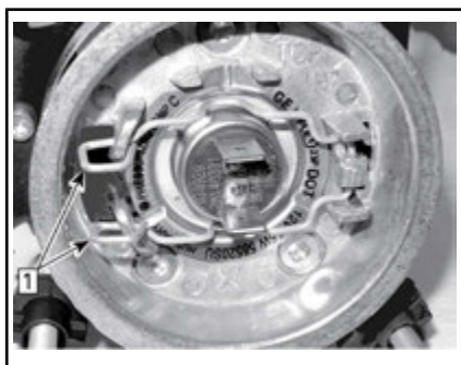
Steg 1: Lossa fjäderklämmorna
