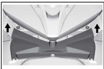
TYPBILD - SKJUT SERVICEKÅPAN PÅ PLATS
