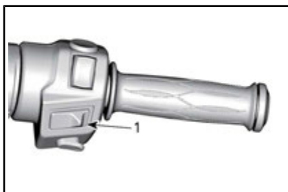
1. Schalter der Geschwindigkeitsregelanlage
