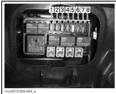
FUSIBLES - BOÎTE À FUSIBLES DROITE
