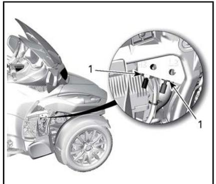
1. Dadi di fissaggio del cavo di regolazione
