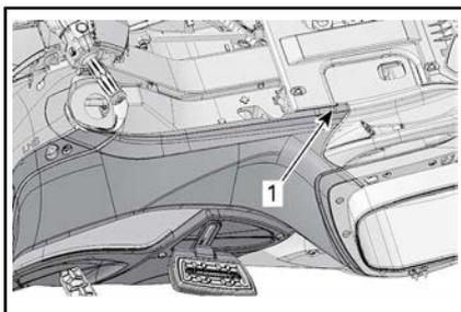
1. Vite di fissaggio superiore
