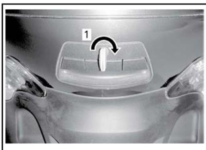
1. Ruotare in senso orario fino al bloccaggio
