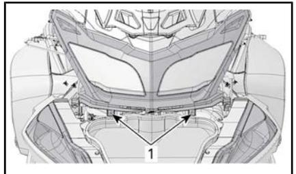
1. Vite di fissaggio inferiore
