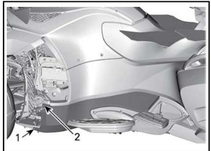
1. Vite di fissaggio inferiore
