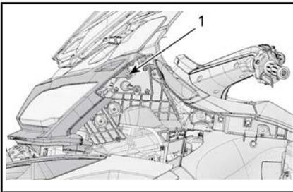
1. Vite di fissaggio superiore
