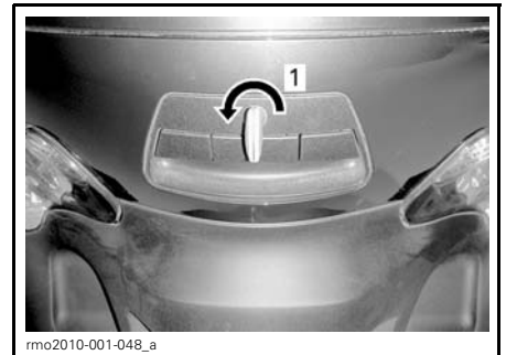
1. Tournez dans le sens antihoraire pour déverrouiller
