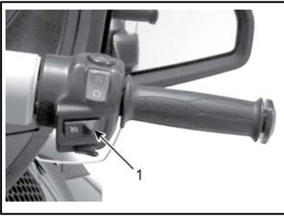
1. Schalter der Geschwindigkeitsregelanlage
