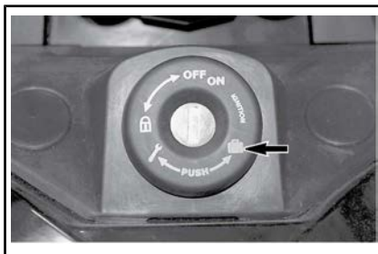
NØKKESTILLING VED ÅPNING AV OPPBEVARINGSROM FORAN
