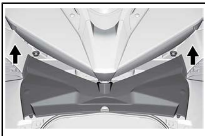
TYPEBILDE - SKYVE SERVICEDEKSEL PÅ Plass
