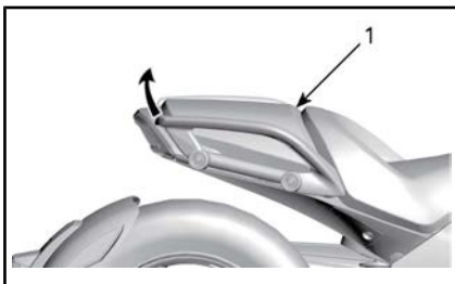
TYPEBILDE - LØFTE PASSASJERSETET FOR Å FJERNE DET
