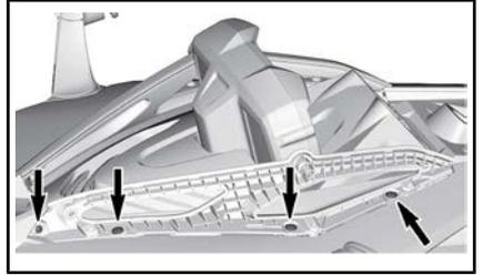
CONFIGURAZIONE TIPICA - VITI DI BLOCCO DA RIMUOVERE
