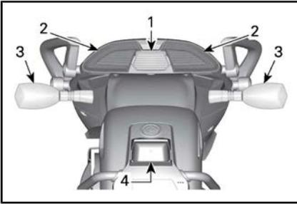
**CONFIGURAZIONE TIPICA - POSIZIONE DELLE LUCI — PARTE POSTERIORE DEL VEICOLO — TUTTI I MODELLI AD ECCEZIONE DEI MODELLI LIMITED, T, NORDAMERICANI E GIAPPONESI**
