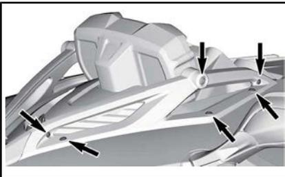
CONFIGURAZIONE TIPICA - VITI DI BLOCCO DA RIMUOVERE
