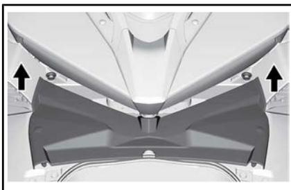
*CONFIGURAZIONE TIPICA - INSERIRE IL COPERCHIO DI MANUTENZIONE IN POSIZIONE*
