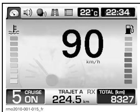
TIPIQUE – VUE DE L'ÉCRAN DE CONDUITE PAR DÉFAUT
