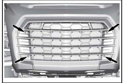
TORNILLOS DE SUJECIÓN QUE DEBEN QUITARSE
