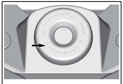
POSICIÓN DE LA LLAVE PARA ABRIR EL ASIENTO
