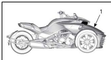
TAPÓN DEL DEPÓSITO DE REFRIGERANTE
