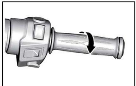
ERHÖHUNG DER MOTORDREHZAHL
