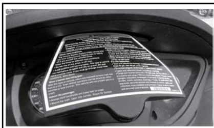
TÍPICO - EXTRACCIÓN DE LA FICHA DE SEGURIDAD
