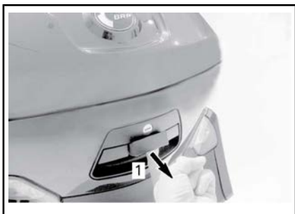
1. Apertura de la cubierta superior
