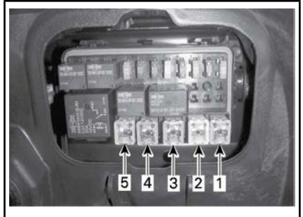
JCASE - ZEKERINGEN - VERZEKERINGSDOOS LINKS
