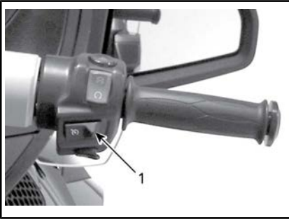
1. Schalter der Geschwindigkeitsregelanlage
