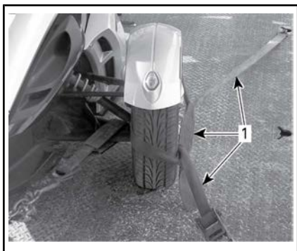
1. Fram- och bakhjulen säkert fastspända på släpet
