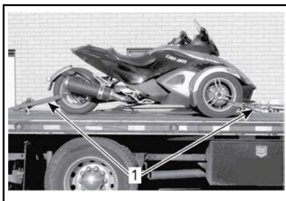
1. Fram- och bakhjulen säkert fastspända på släpet
