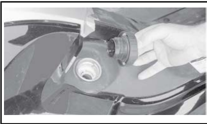
POLTTOAINESÄILIÖN KORKKI ISTUIMEN ALLA, VASEMMALLA PUOLELLA
