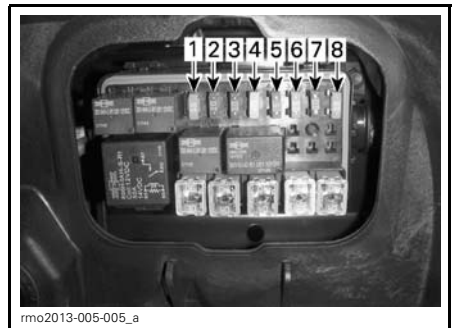
FUSIBLES - BOÎTE À FUSIBLE GAUCHE
