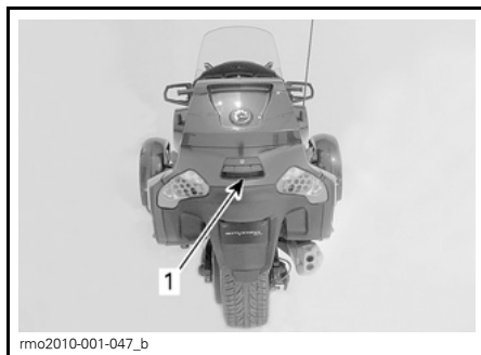
1. Lås for det øvre oppbevaringsrommet
