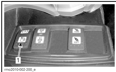
1. Bryter for oppbevaringsrom foran
