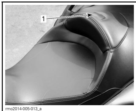
1. Tilgangsdeksel for ryggstøtte
