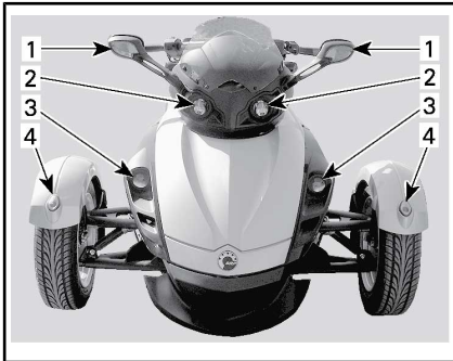
TYPISCHERWEISE - LEUCHTENANORDNUNG — FAHRZEUGVORDERSEITE
