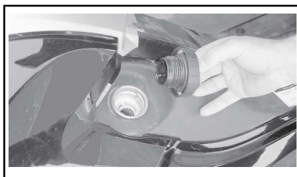
EL TAPÓN DEL DEPÓSITO DE COMBUSTIBLE ESTÁ EN EL LADO IZQUIERDO DEBAJO DEL ASIENTO
