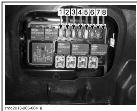
SÄKRINGAR - HÖGER SÄKRINGSBOX
