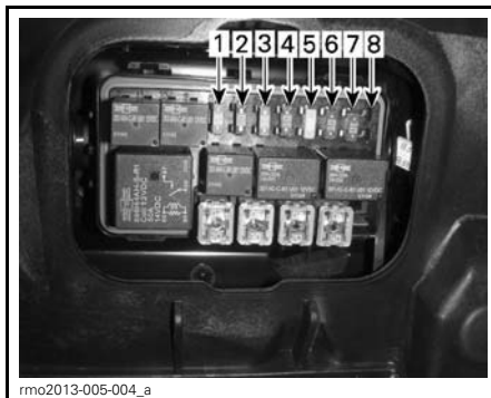
FUSIBLES - BOÎTE À FUSIBLES DROITE
