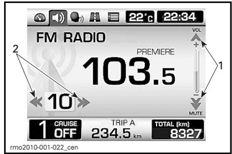
1. Zum Bedienen der vertikalen Pfeile den Taster NACH OBEN/NACH UNTEN verwenden
