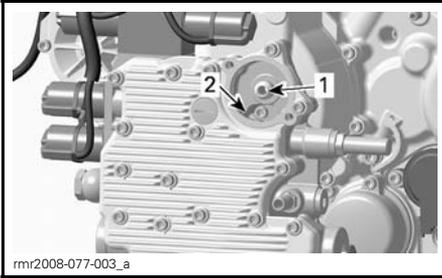
1. Ölauslassöffnung zum Schmiersystem des hydraulischen Steuergeräts
