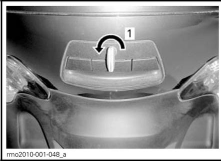
1. Zum Entriegeln gegen den Uhrzeigersinn drehen
