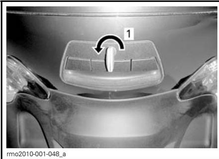
1. Zum Entriegeln gegen den Uhrzeigersinn drehen
