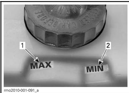
1. Markierung für MAX. Bremsflüssigkeitsstand
