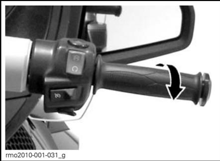
ERHÖHUNG DER MOTORDREHZAHL
