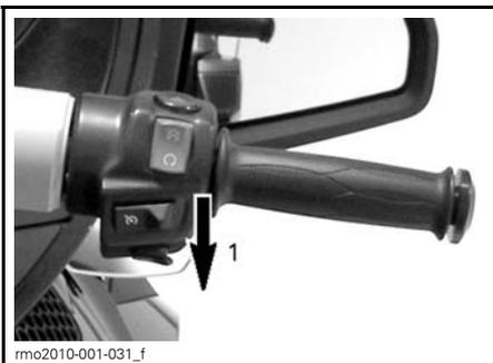
1. Taster nach Setzen bzw. Speichern der Geschwindigkeit nach unten in die Stellung SET drücken
