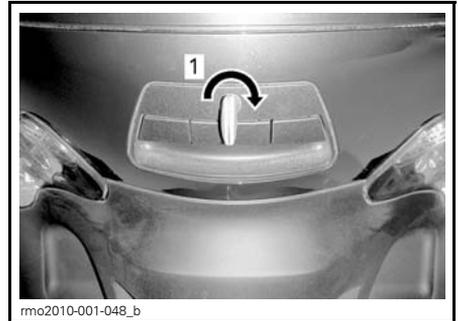
1. Zum Verriegeln im Uhrzeigersinn drehen
