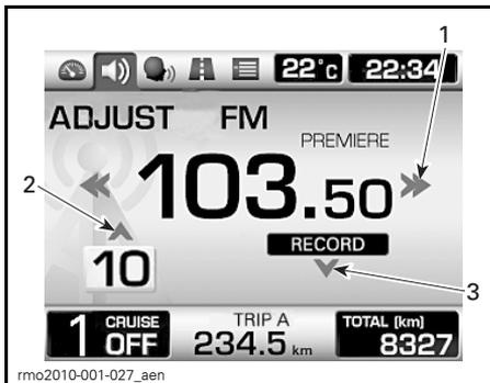
1. Taster NACH LINKS/NACH RECHTS zum Auswählen der Frequenz
