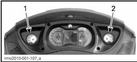
1. Anzeigeeinstrument für Kraftstoffstand
