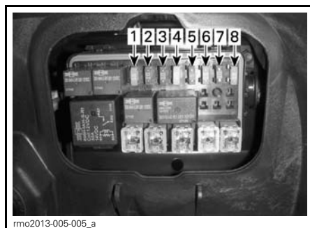
FUSÍVEIS - CAIXA DE FUSÍVEIS ESQUERDA
