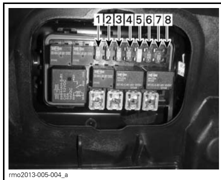
FUSIBLES - CAJA DE FUSIBLES DERECHA
