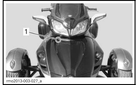
1. Etiqueta 5 situada debajo de la cubierta de servicio
