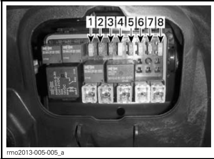
FUSÍVEIS - CAIXA DE FUSÍVEIS ESQUERDA
