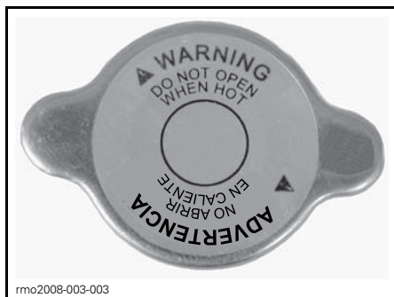
TAPÓN DEL DEPÓSITO DE REFRIGERANTE
