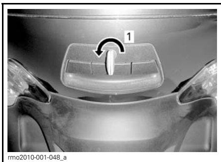
1. Gire en sentido contrario al de las agujas del reloj para desbloquear
