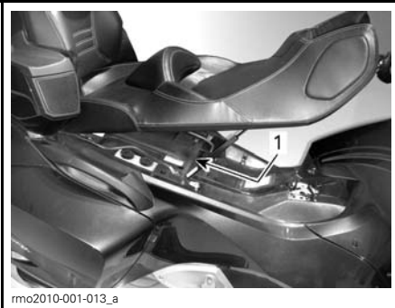
1. De zekeringenkast onder het zadel
